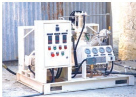
6 Flaschen mit einer Kapazität von 6800 Litern kann die Maschine innerhalb von 24 Stunden gleichzeitig füllen.
